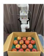
ロボットに作業前と作業後の画像を記憶させ、最適な動きを自動で考える。複雑なプログラミング知識がなくても利用できる。
